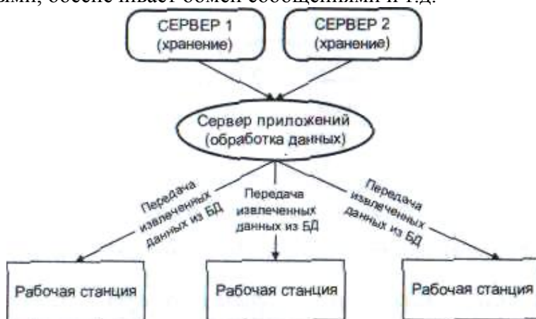
Рис.6. Трехуровневая система «сервер приложений»
