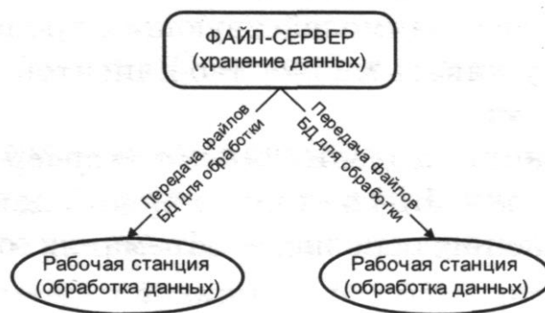
Рис.1. Обработка информации в модели файл-сервер
