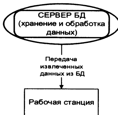
Рис. 4. Двухуровневая система «один клиент — один сервер»
