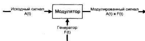
Рис.2. Принцип работы аналогового модема
